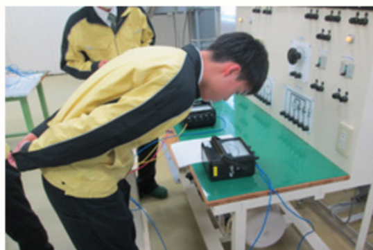
変圧器の三相結線特性試験
